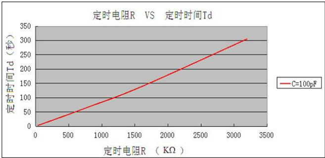
图 3. ONTMIE 脚接 100pF 电容到地
